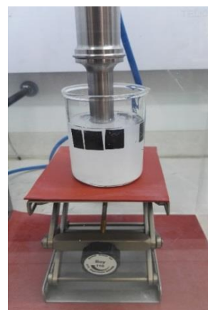
شکل ۱ نمایی از راکتور تحت تابش و محل قرار گرفتن نمونه‌ها در قسمت زیر و کنار پروب مولد امواج فراآوا.
