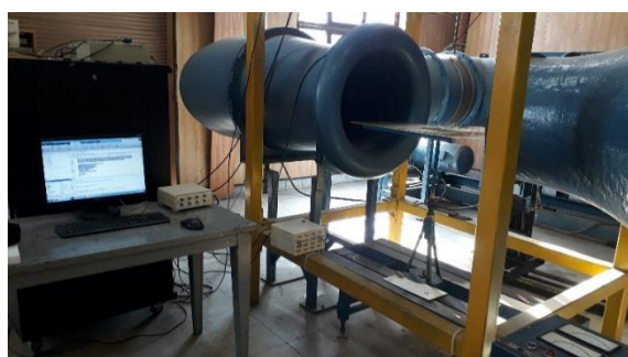
شکل ۱۵ چینش صفحه تخت در تونل باد.
