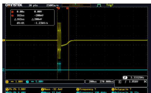
شکل ۱۶ خروجی کلید ارسال و دریافت در حالت قطع تراگذار.
