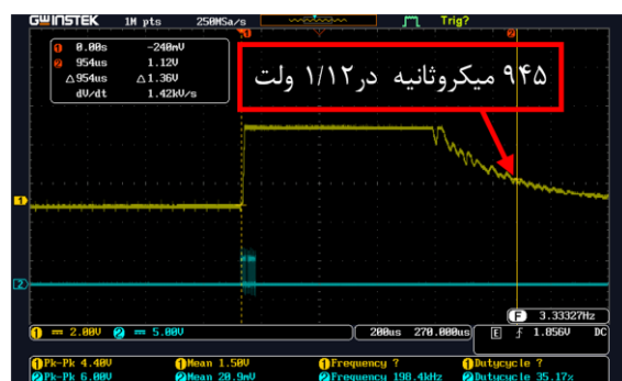
شکل ۱۷ خروجی علامت پوش در حالت وصل تراگذار.
