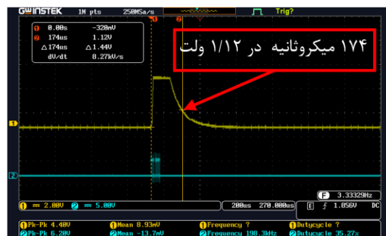
شکل ۱۸ خروجی علامت پوش در حالت قطع تراگذار.
