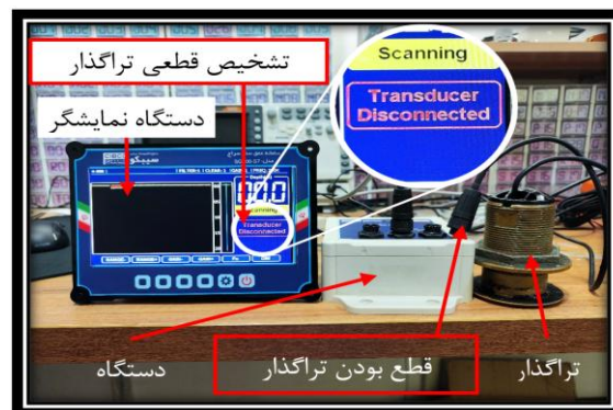
شکل ۲۰ عملکرد دستگاه کامل پژواک‌سنج-صدا در حالت قطع.
