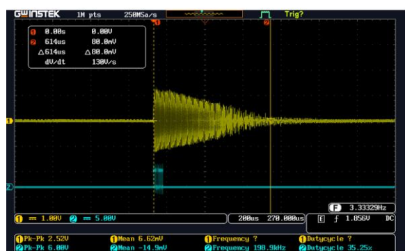
شکل ۱۵ خروجی کلید ارسال و دریافت در حالت وصل تراگذار.
