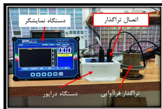
شکل ۱۹ عملکرد دستگاه کامل پژواک‌سنج-صدا در حالت وصل.
