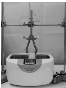
شکل ۱ سامانه تابش‌دهی فراآوایی به محلول دزیمتر.
