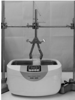
شکل ۱ سامانه تابش‌دهی فراآوایی به محلول دزیمتر.
