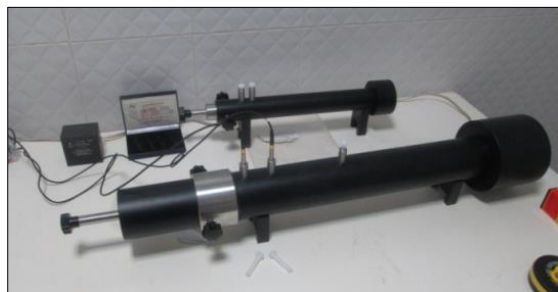
شکل ۷ لوله مقاومت‌ظاهری مورد استفاده در آزمون آزمایشگاهی.
