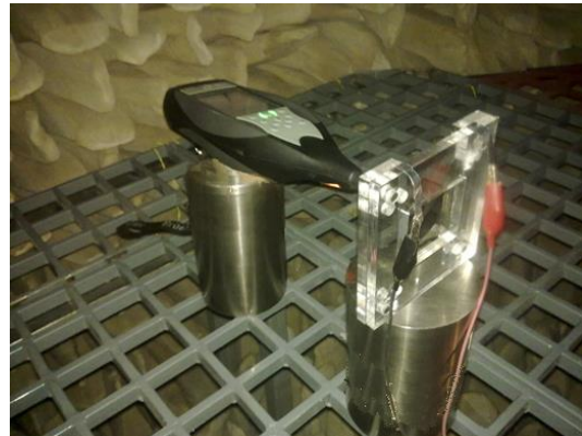
شکل ۵ قرارگیری نهایی عملگر و دستگاه سنجش سطح صدا در اتاق ناپژواک.
