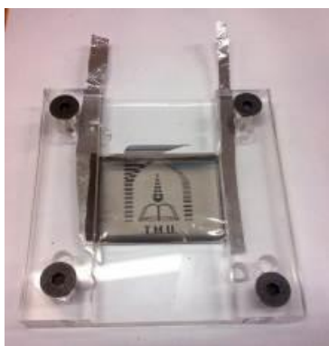
شکل ۴ حسگر و عملگر نهایی ساخته‌شده.
