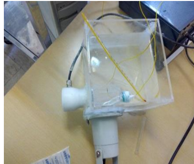
شکل ۱ چیدمان قرارگیری پروب‌های فراصدا و فلاسک محتوی یاخته. دماسنج حیوانی برای اندازه‌گیری دمای محیط و دو ریزدماسنج برای پایش دمای فلاسک در طول تابش قرار داده شده است.
