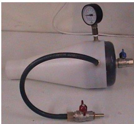
شکل ۵ حجم خنثی به همراه تجهیزات آن.
