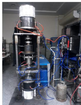
شکل ۱. آزمونگر شعله جریان متقابل با تحریک صوتی.
