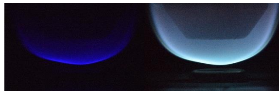
شکل ۸ شعله جریان متقابل (راست) و تصویر نورتایی شیمیایی سی‌اچ‌اِستار با صافی اپتیکی ۴۳۰ نانومتر (چپ) قبل از تحریک صوتی.
