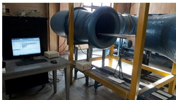
شکل ۱۵ چینش صفحه تخت در تونل باد.
