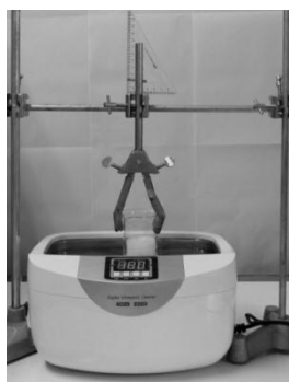
شکل ۱ سامانه تابش‌دهی فراآوایی به محلول دزیمتر.
