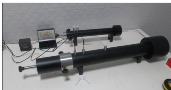
شکل ۷ لوله مقاومت ظاهری مورد استفاده در آزمون آزمایشگاهی.
