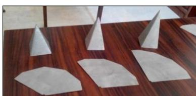
شکل ۴ برش گستردۀ ورق سوراخ دار و نمای خمشده بهصورت هندسه هرمی.
