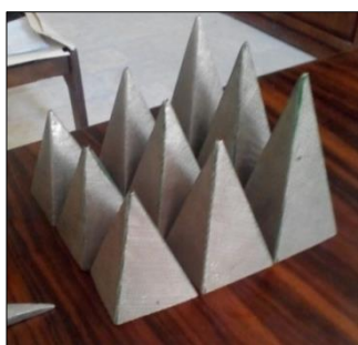
شکل ۵ سه نمونه از هر زاویه رأس جهت کاهش اثر خطاهای جزئی در ساخت.
