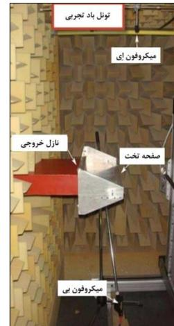
شکل ۲ نحوه قرارگیری صفحه تخت در تونل باد [۱۵].
