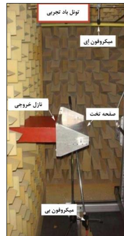
شکل ۲ نحوه قرارگیری صفحه تخت در تونل باد [۱۵].
