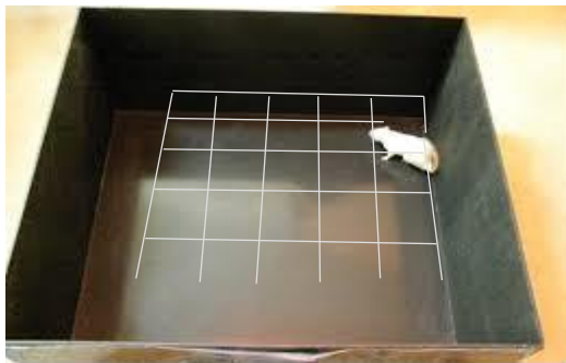
شکل ۳ جعبه آزمون میدان باز: حیوان در جعبه‌ای که توسط نرم‌افزار به ۲۵ مربع تقسیم‌بندی شده است، قرار داده می‌شود و حرکات آن به مدت ۱۵ دقیقه توسط دوربین ثبت می‌شود.
