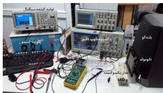
شکل ۳ سامانه استفاده‌شده برای آزمون نانومولد صوتی.
