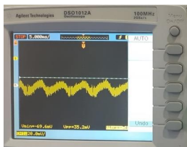
شکل ۱۲ نوسان ولتاژ آشکارساز در اثر اعمال امواج صوتی به نوک الیاف نوری.
