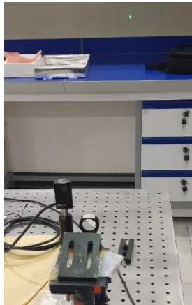
شکل ۱۱ جلوگیری از پراکندگی نور با استفاده از عدسی.
