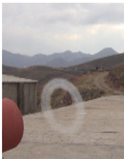
شکل ۱۱ گردابه تولیدشده در آزمون‌های اولیه.
