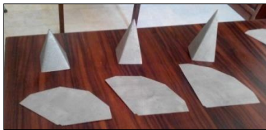
شکل ۴ برش گسترده ورق سوراخدار و نمای خم‌شده به‌صورت هندسه هرمی.
