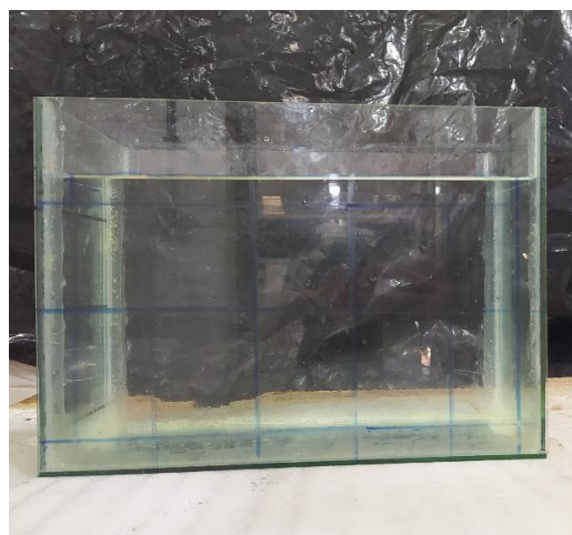
شکل ۲ نمای روبرو (جلویی) از تانک‌ماهی و مختصات‌های نشانه‌گذاری شده برای اندازه‌گیری فشار صوتی؛ نقاط مختصاتی علامت‌گذاری شده محل‌های اندازه‌گیری موج صوتی در تانک می‌باشند.
