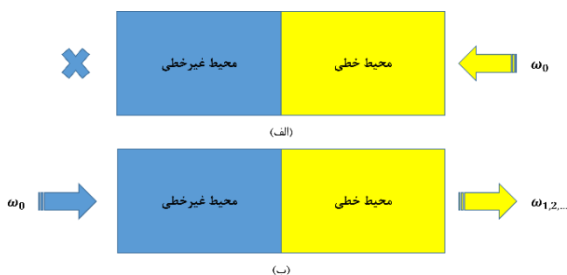
شکل ۳ ساختار کامل دیود صوتی غیرخطی پیشنهادی با نمایش روند تابش موج از (الف) سمت محیط خطی و (ب) محیط غیرخطی.
