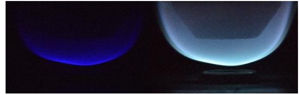
شکل ۸ شعله جریان متقابل (راست) و تصویر نورتایی شیمیایی سی‌اچ‌اِستار با صافی اپتیکی ۴۳۰ نانومتر (چپ) قبل از تحریک صوتی.
