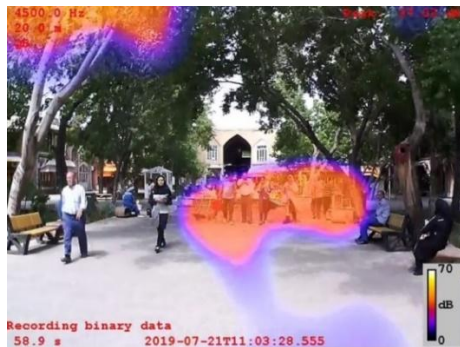
شکل ۴ نمونه‌ای از یک قاب برداشت‌شده توسط دوربین صوتی [نگارنده، ۹۸/۴/۳۰؛ بازار تبریز، سرای حاج حسینی میانی].
