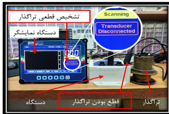
شکل ۲۰ عملکرد دستگاه کامل پژواک‌سنج-صدا در حالت قطع.
