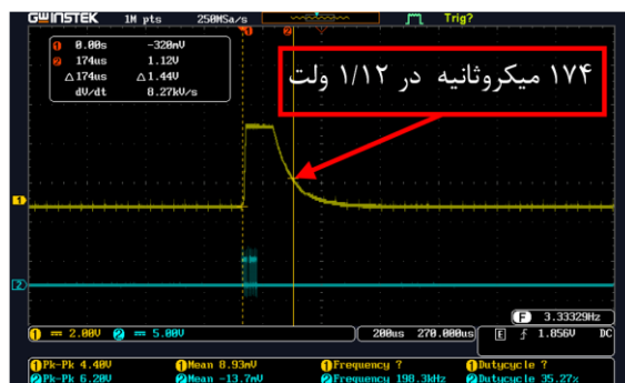
شکل ۱۸ خروجی علامت پوش در حالت قطع تراگذار.
