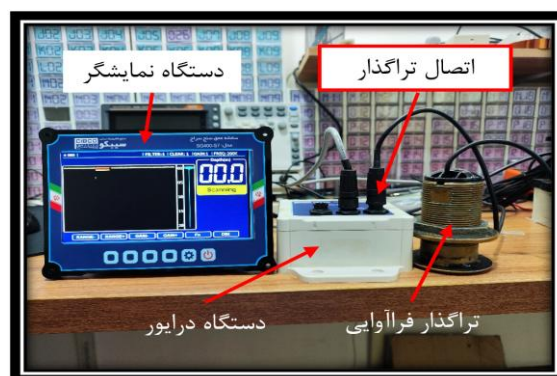
شکل ۱۹ عملکرد دستگاه کامل پژواک‌سنج-صدا در حالت وصل.
