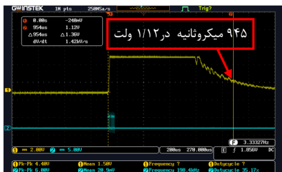
شکل ۱۷ خروجی علامت پوش در حالت وصل تراگذار.
