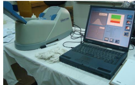
شکل ۱ تنظیم دستگاه فراآوایی سنست ۲۰۰۰ برای خوانش پارامترهای صوتی سرعت، ضریب تئکس و شاخص کیفی.
