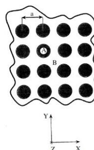
شکل ۲ چیدمان استوانه‌های فلزی در زمینه اپوکسی.
