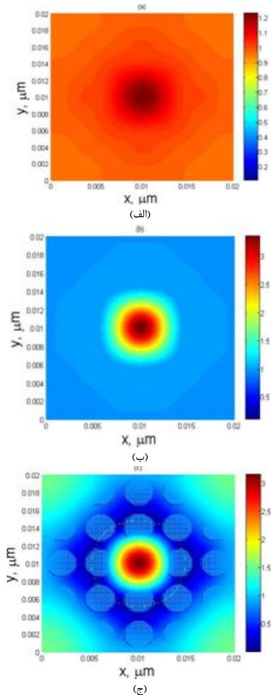
شکل ۹ نقشه میدان جابه‌جایی کشسان در بلور فونونی دو-بعدی شامل یک شبکه مربعی ساخته شده از  $5 \times 5$  استوانه‌های توپر نیکل که در زمینه اپوکسی جاسازی شده است. مد اول الف) ( $r/a=1$ ؛ ب) که در زمینه اپوکسی بر حسب بسامد بهنجار شده.  $r/a=1/4$  و ج) مد دوم در  $r/a=1/4$ .
