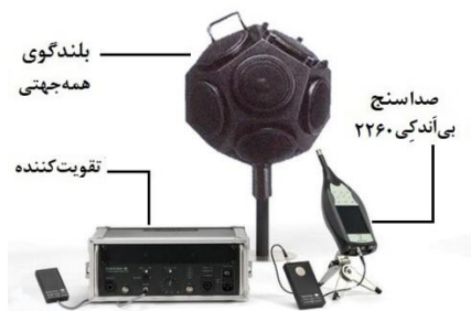
شکل ۷ مجموعه بلندگوی همه‌جهتی، تقویت‌کننده و صداسنج بی‌اندکی ۲۲۶۰ [نگارنده]
