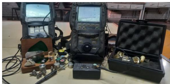
شکل ۵ تنظیمات واسنجی دستگاه با بلوک‌های استاندارد و مولدهای بسامدهای مختلف.
