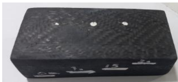
شکل ۶ آزمون بلاک‌های ساخته شده از الیاف کربن در ضخامت‌های ۳۰ میلی‌متر با پارچه توییل ۲۰۰ گرم دوجته.
