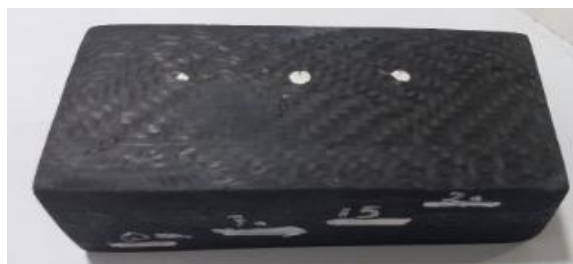
شکل ۶ آزمون بلاک‌های ساخته شده از الیاف کربن در ضخامت‌های ۳۰ میلی‌متر با پارچه توپیل ۲۰۰ گرم دوجته.
