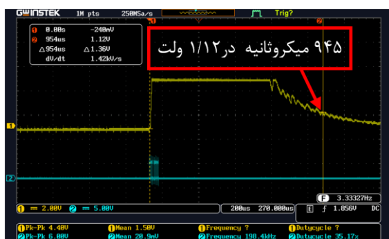
شکل ۱۷ خروجی علامت پوش در حالت وصل تراگذار.
