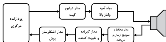
شکل ۲. بلوک دیاگرام یک سامانه فرستنده و گیرنده فراآوایی.
