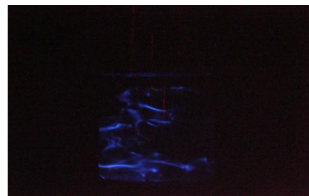
شکل ۴ آشکارسازی حضور رادیکال‌های هیدروکسیل با لومینول، پس از قرار گرفتن در معرض امواج فراصدا.
